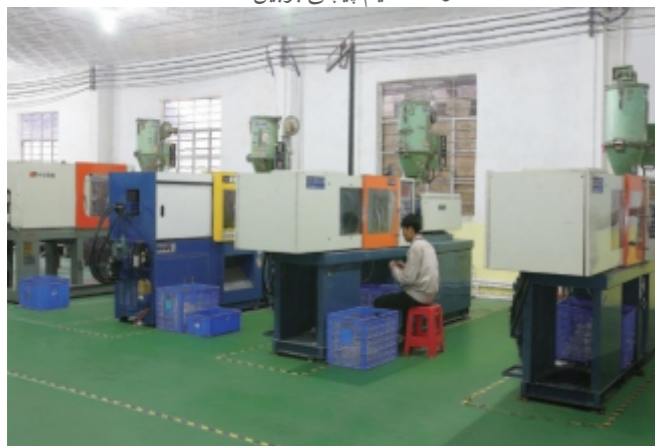
▲ واحد تزريق قطعات پلاستيك
